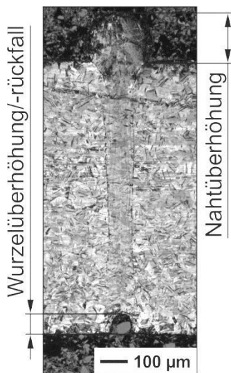
Abb.9: Schweißnaht mit Nahtüberhöhung und Wurzelrückfall (Parameter: 2w_0 = 65 \mu\text{m} , Edelstahl)
